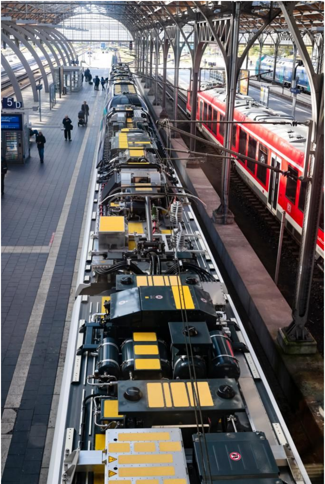
Akkutechnik auf dem Dach des Zugs im Lübecker Hauptbahnhof: Gelegenheit zum Nachladen
